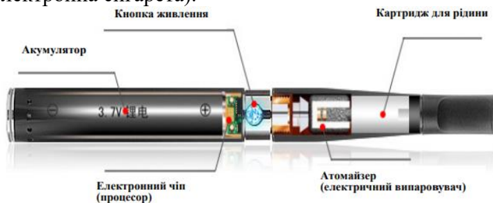
Рис. 2. Структура електронної сигарети
